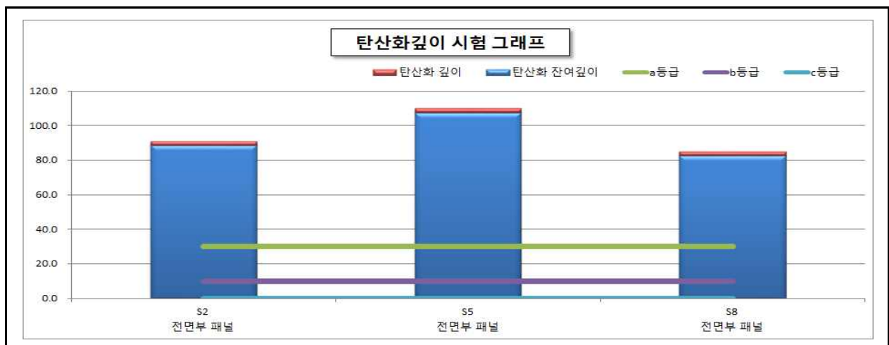
【그림 5.4.3】 탄산화 깊이 측정결과
